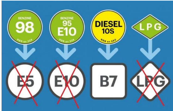
Afb. 1.6.1 codering diesel bij tankstations
