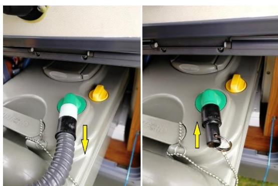
Afb. 5.6.4 chemisch toilet ontluchting
